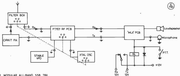
Fig. 1 MODULAR ALL-BAND SSB TRX
