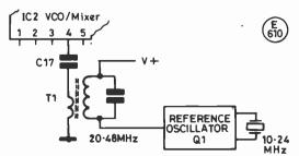
Fig. 4 FREQUENCY INJECTION INTO DOWN MIXER
