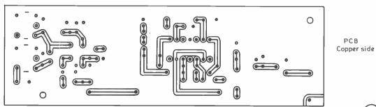
Fig. 2 JLD RECEIVER PCB LAYOUT (Actual size)
