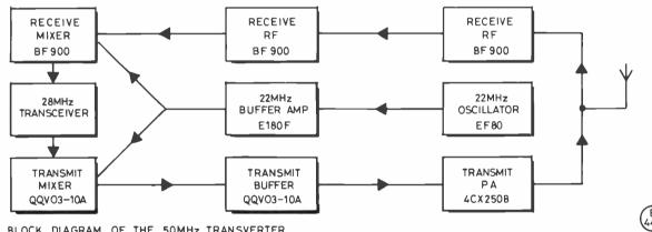
BLOCK DIAGRAM OF THE 50MHz TRANSVERTER
