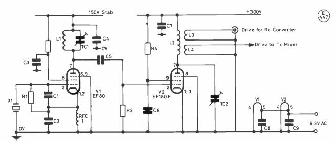
CIRCUIT OF 22MHz LOCAL OSCILLATOR AND BUFFER
