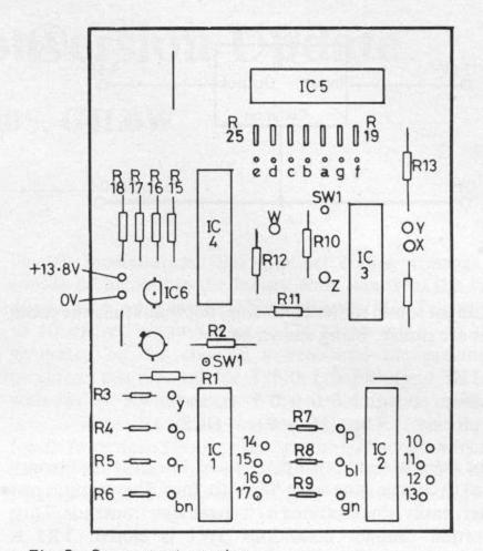
Fig. 5 Component overlay
