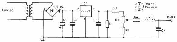
Fig. 1 NEGATIVE VOLTAGE SUPPLY FOR IC-730 POWER CONTROL
