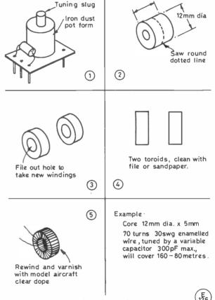
Fig.1 IRON DUST TOROIDS FROM IF TRANSFORMERS
