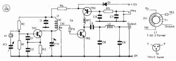
Fig. 6 SIMPLE TRANSMITTER CIRCUIT
