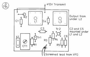
Fig.4 TRANSMIT MIXER LAYOUT (actual size)
