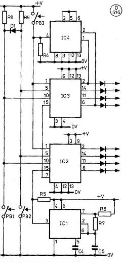
Fig. 3 SCANNER CIRCUIT DIAGRAM
