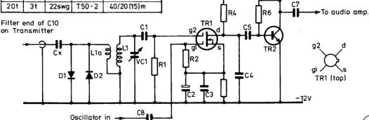
Fig. 1. "S.C.D" RECEIVER MIXER CIRCUIT
