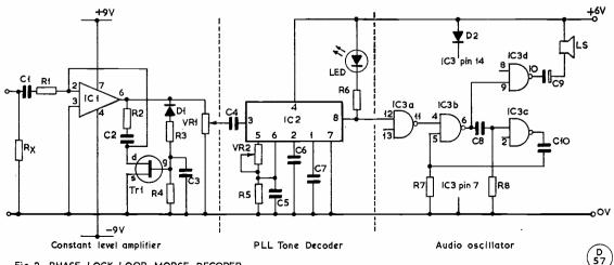
Fig.2 PHASE LOCK LOOP MORSE DECODER
