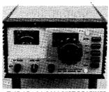
THE ARAC 102 MOSFET RECEIVER 28-30 MHz. 144-146 MHz. AM, FM, SSB. 12v. DC.
