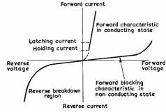
Fig. 4. TYPICAL STATIC CHARACTERISTIC OF THYRISTOR
