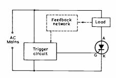
Fig. 5. BASIC POWER CONTROL CIRCUIT
