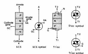
Fig. 7. SILICON CONTROLLED SWITCH, THE DIAC & TRIAC
