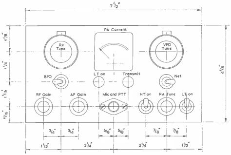
Fig. 4: FRONT PANEL LAYOUT
