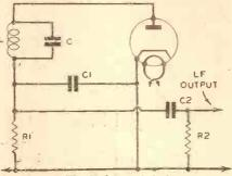
Fig. 1.- The fundamental diode circuit.
