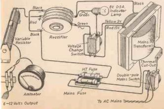
Fig. 5.—Wiring diagram.
