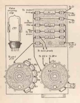
Fig. 3.-Wiring the actual lie detector.
