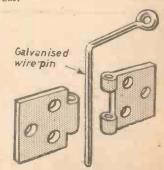
Fig. 7 .- Backflap hinge modification.
