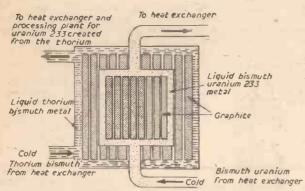
Fig. 7 .- Liquid metal breeder reactor.
