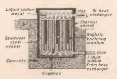
Fig. 3 .- Sodium graphite reactor.
