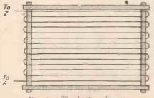
Fig. 2 .- The heater element.
