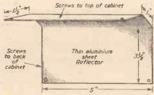
Fig. 8 .- The aluminium reflector.
