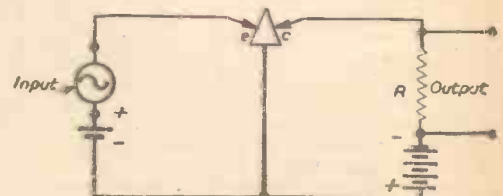
Fig. 3.—A triode amplifier circuit.
