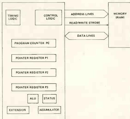
FIG. 1. SC/MP SYSTEM BLOCK DIAGRAM
