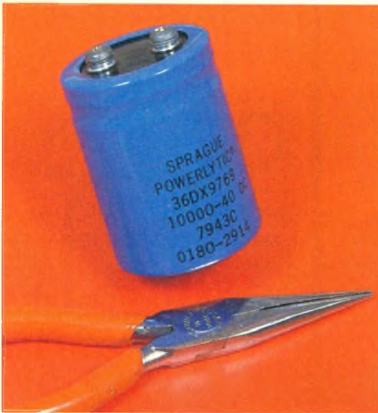
Photo 3 – Vue d'une capacité électrochimique de 10 000 \mu\text{F}/40\text{ V} , utilisable dans l'alimentation de puissance.
