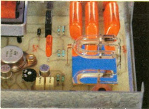
Un petit miroir pourra être fixé sous le tube à éclats, de façon à améliorer l'efficacité lumineuse
