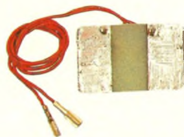
Photo 4 – Le capteur d'humidité se compose d'un circuit imprimé étamé.
