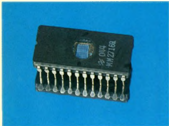
Photo 3. - Aperçu d'une Eprom 2716 (ROM dont le contenu peut être effacé à l'aide d'ultra-violets).
