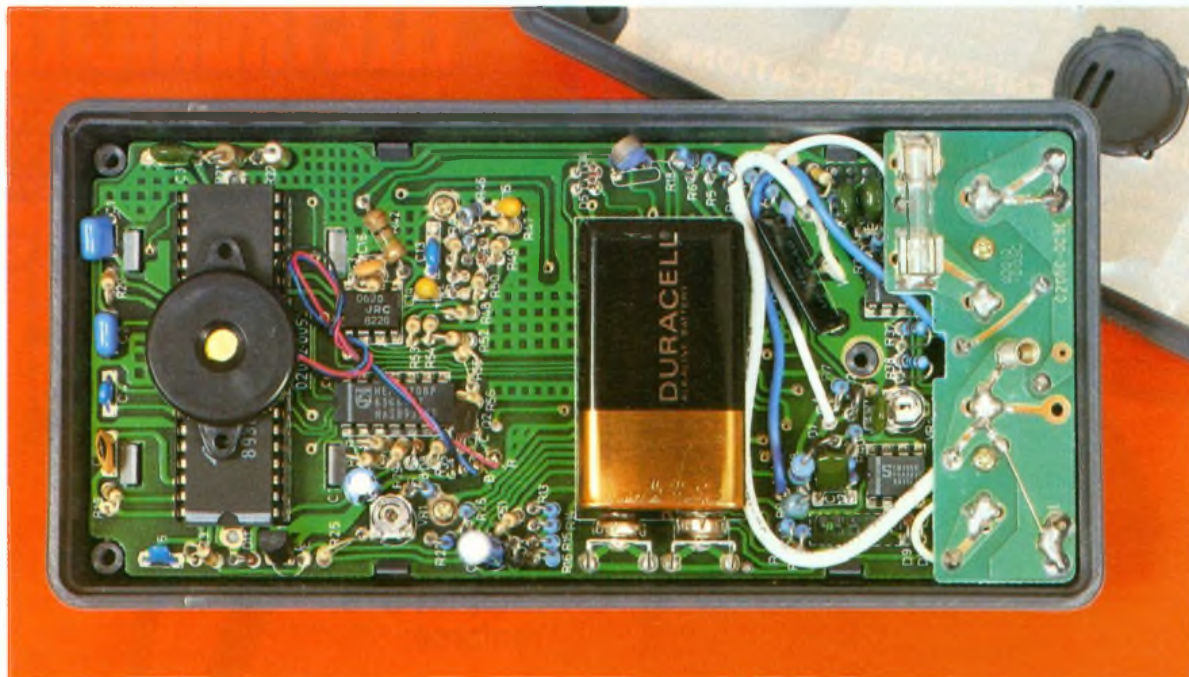
Photo 2. – Le circuit intégré gère la mesure et l'affichage digital LCD. Le buzzer piézo-électrique situé sur le dessus fournit le bip sonore du test de continuité tandis que l'on aperçoit sur la droite le fusible de protection
