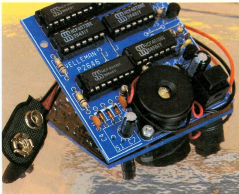
Gros plan du buzzer piézo comportant un oscillateur incorporé.
