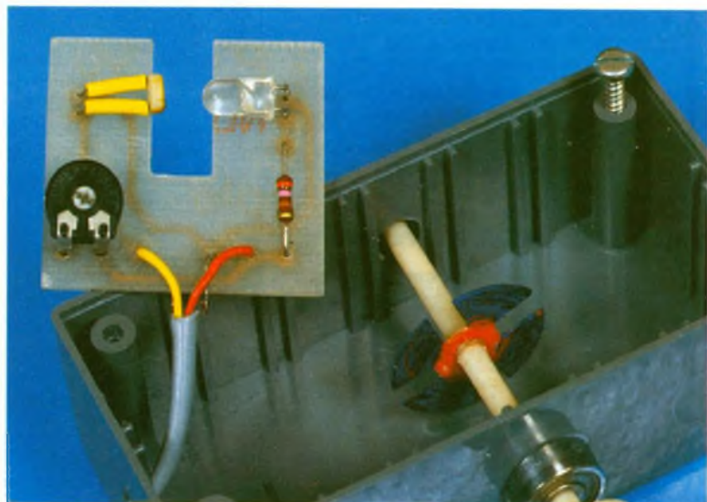
Photo 2. - La platine de détection comporte un couple LDR-LED, obstrué périodiquement par les secteurs d'un disque découpé.
