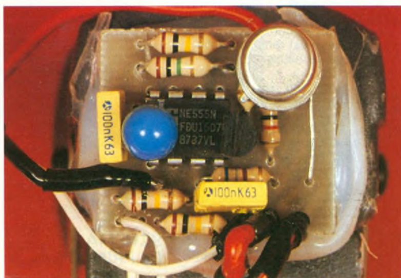
Photo 2 – Vue du module fixé à l'aide d'une colle sur le H.P.
