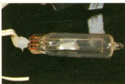
Photo 3. – L'interrupteur au mercure réalisant la détection du basculement de la moto.
