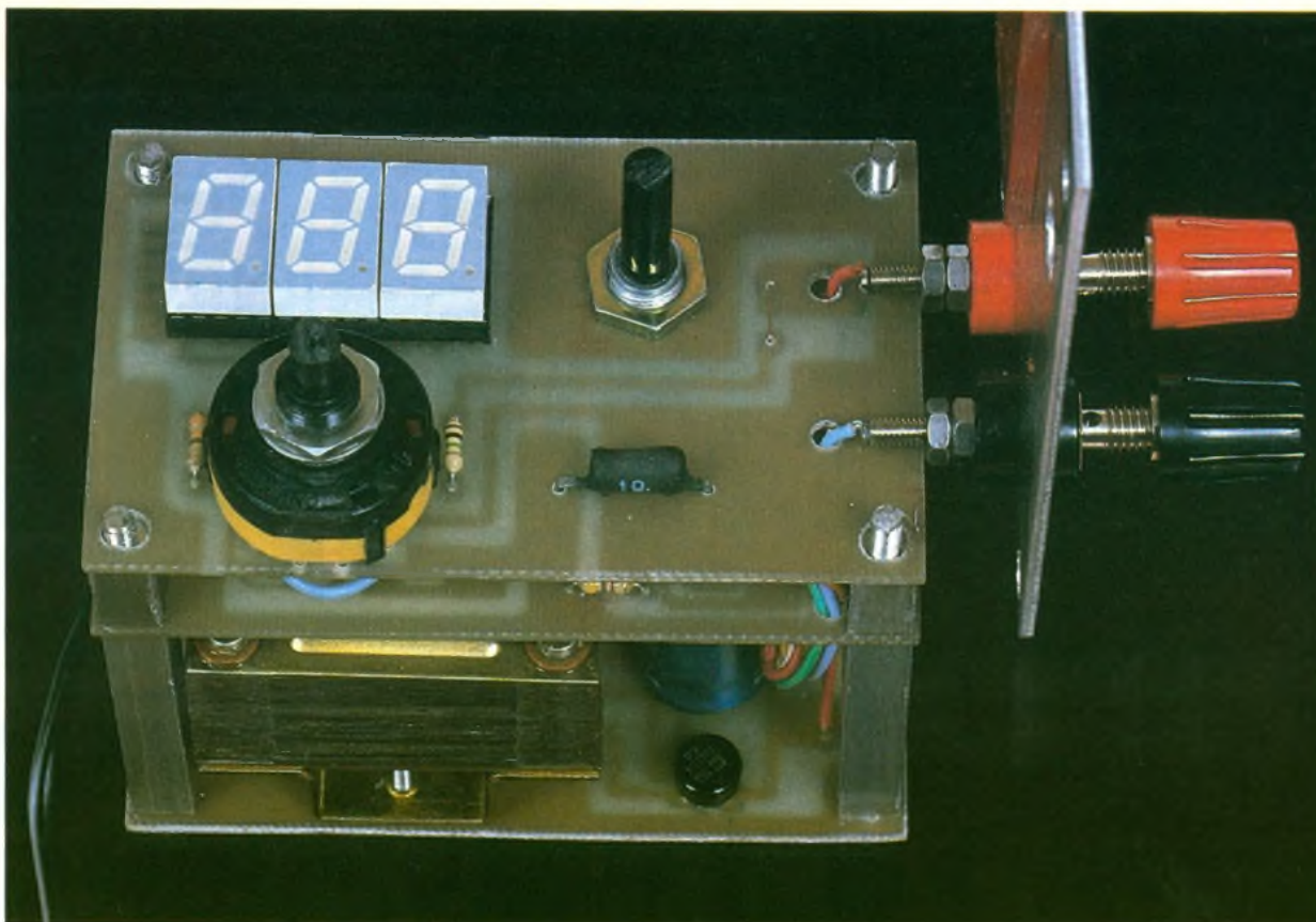
Photo 2. – La platine supérieure supporte l'affichage, le potentiomètre de tension et le rotacteur sélectionnant la mesure à réaliser.
