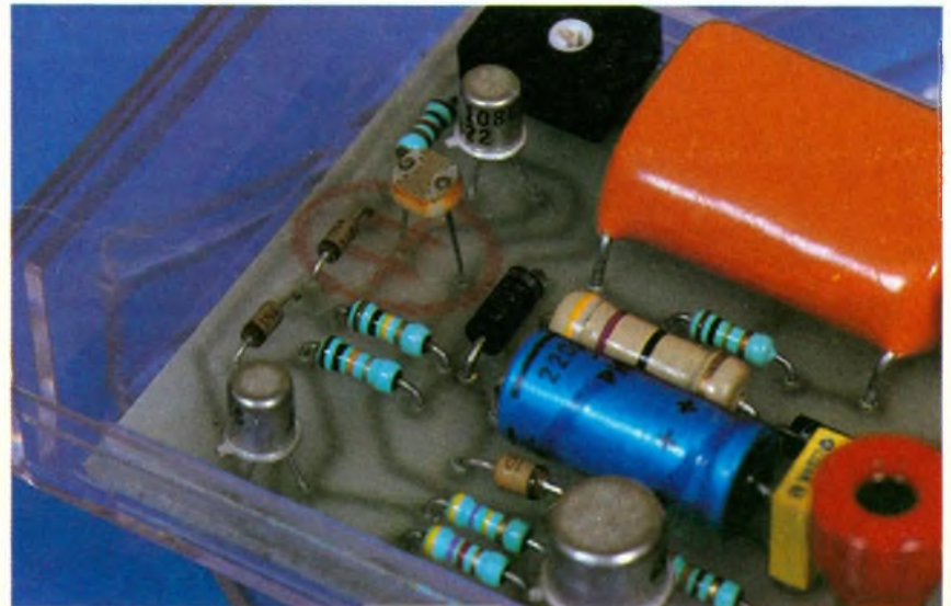
Photo 2. - Le condensateur C1, de couleur orange, reste relativement imposant, vue sa tension de service de 400 V.
