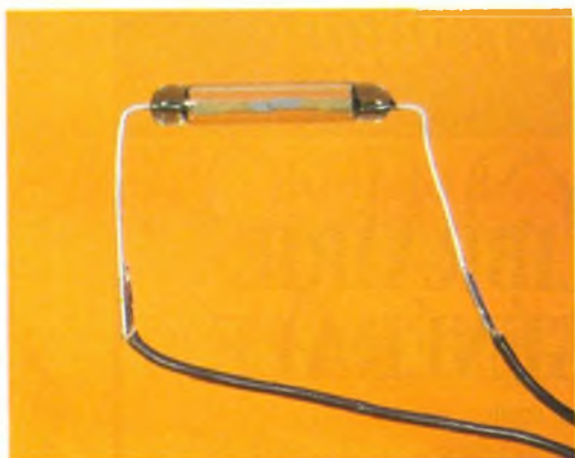
Photo 5. - La détection composée d'un ILS.
