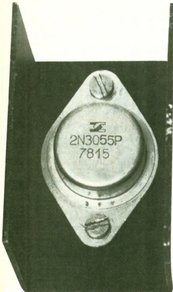
Photo 7. — Le radiateur facilite la dissipation de la chaleur.
