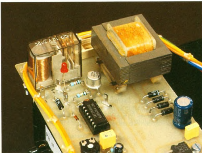
Photo 4. – Vue du transformateur d'alimentation et du relais de sortie.
