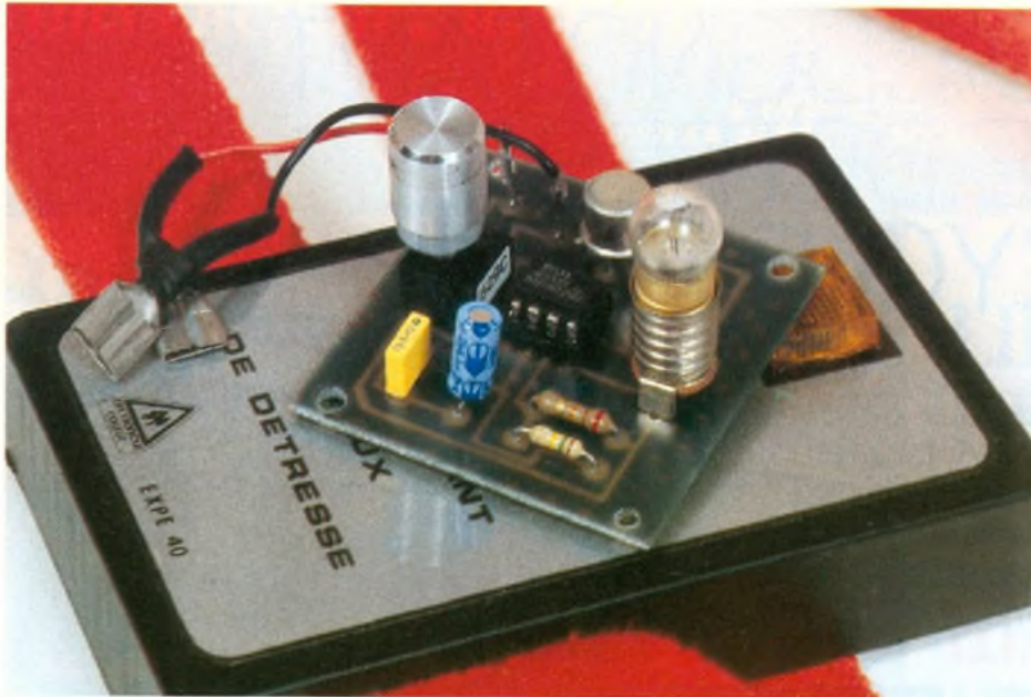
Photo 2 – Afin de faciliter le montage ou le dépannage, on utilisera un support de circuit intégré.
