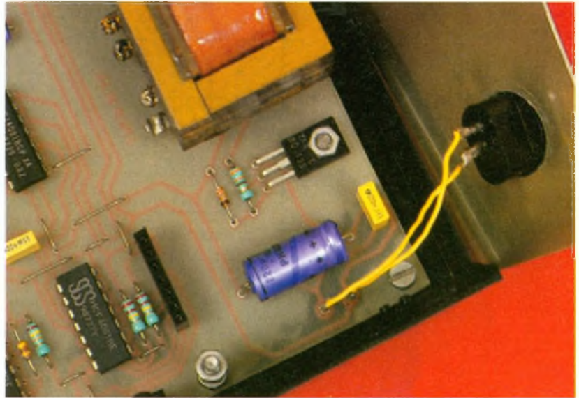
Photo 3. – Vue de la section alimentation incluant le transformateur, la stabilisation et le filtrage.
