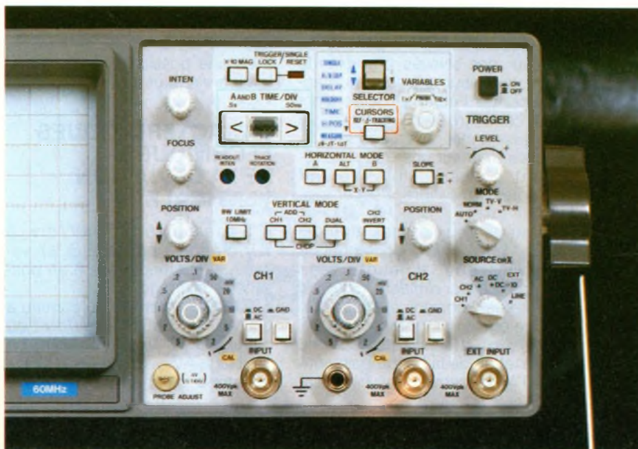
Photo 2. - Ensemble de la commande des curseurs numériques.
