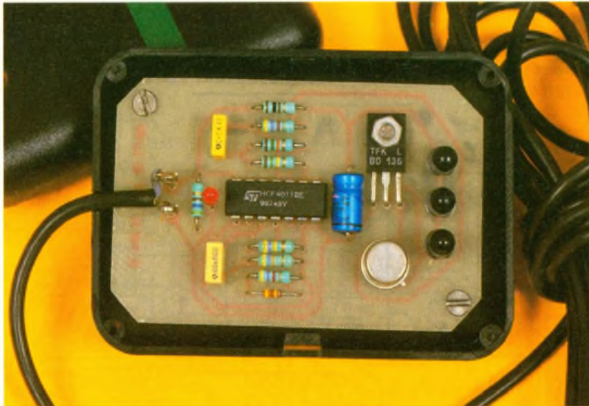
Photo 5 – A droite sur le circuit imprimé se situent les trois diodes émettrices I R.
