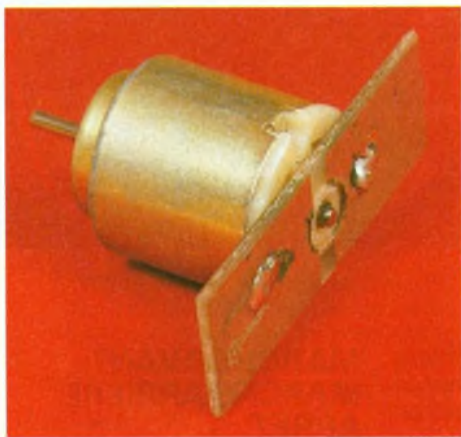
Photo 2. - Vue d'un petit moteur monté sur circuit imprimé.
