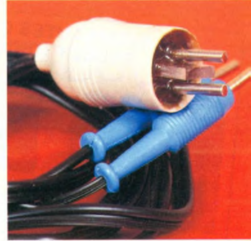
Photo 4 - La sonde, logée dans un capuchon de fiche de haut-parleur
