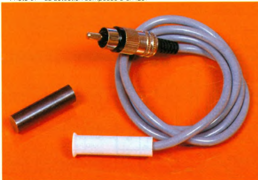
Photo 6. - La détection composée d'un ILS.
