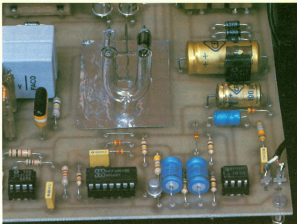
Photo 2. - Simple réflecteur de fortune pour le tube à éclats.
