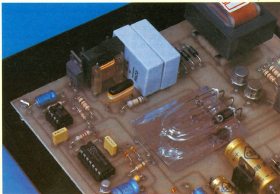
Photo 3. - Le transformateur d'impulsion et les condensateurs 1 \mu F/600 V.
