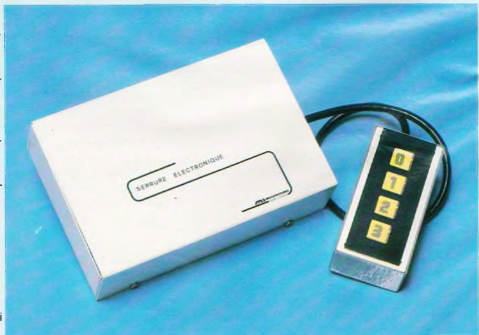
Photo 2. — Aspect de la réalisation. Le clavier souple sera collé sur le coffret.
