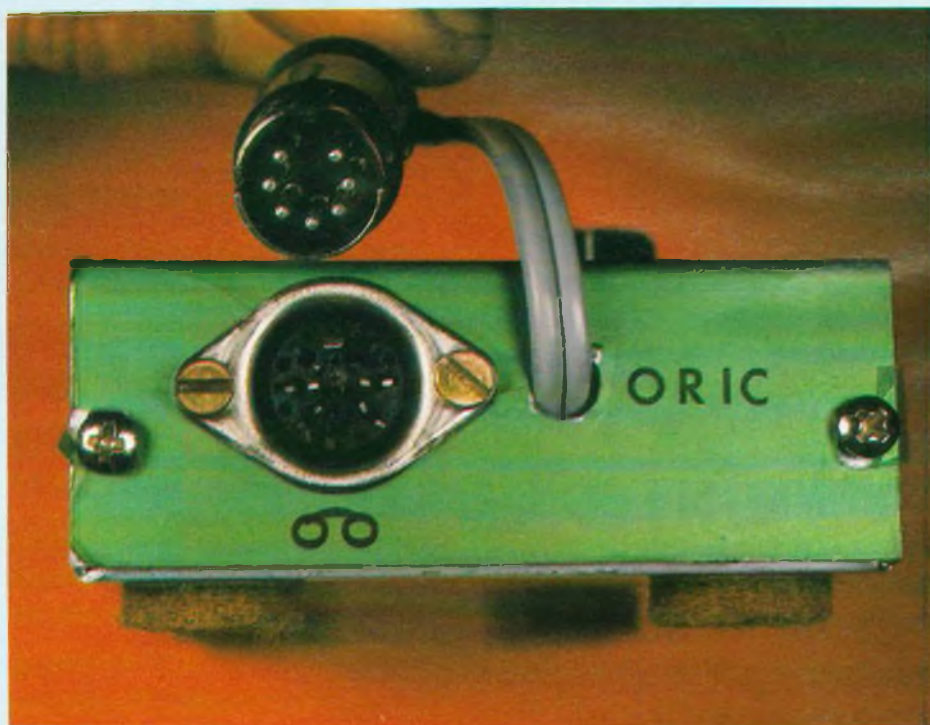
Photo 4. – Détails des entrées/sorties en DIN 7 broches.
