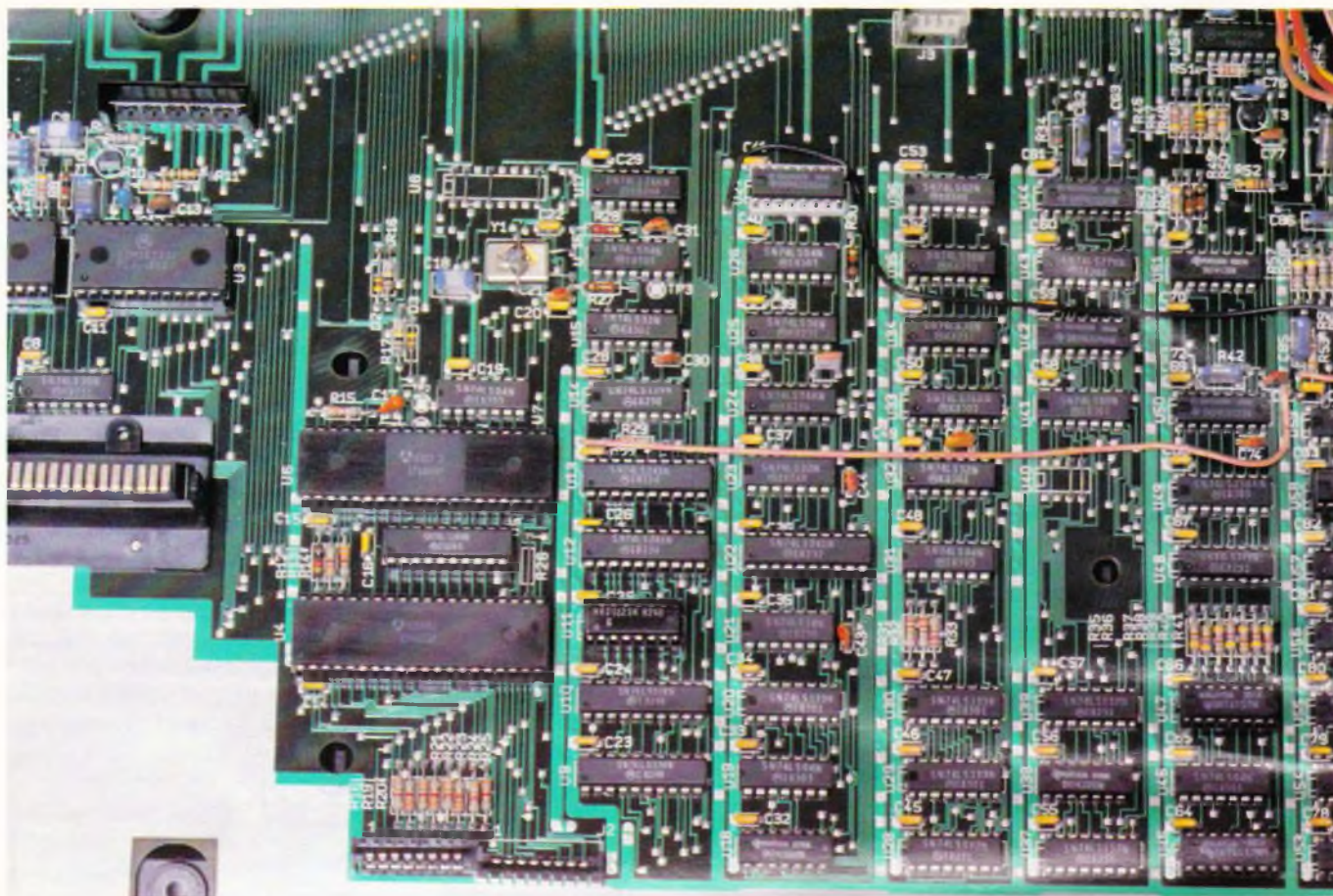
Vue intérieure de la carte imprimée principale.
