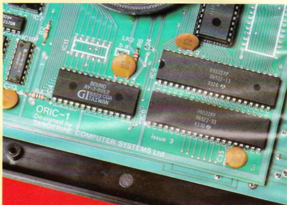
Photo 3. – Les « gros circuits » processeur 6502 A, synthétiseur AY 8912.
