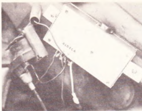
Photo 4. - L'appareil doit être fixé le plus près possible de la bobine. Ici sur Opel Kadett.
