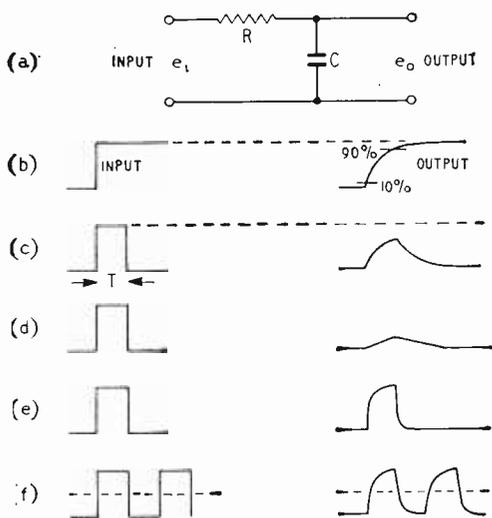
Fig. 59. Low-pass RC filter (integrator): (a) basic circuit, (b) step input, (c) pulse input ( $RC = T$ ), (d) pulse input ( $RC > T$ ), (e) pulse input ( $RC \ll T$ ), (f) pulse train.
