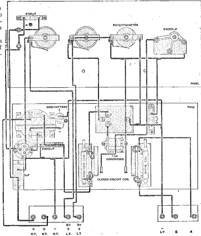
Fig. 4.—The wiring diagram.
