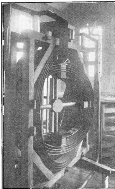
Fig. 3. The variocoupler.
