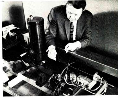
TERRAIN PROFILER USES LASER
