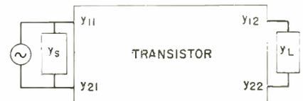
Transistor "y" parameters
