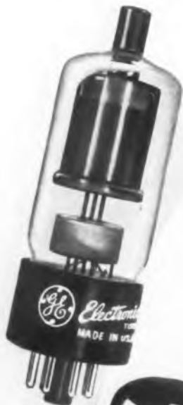
2V2 High-voltage rectifier
