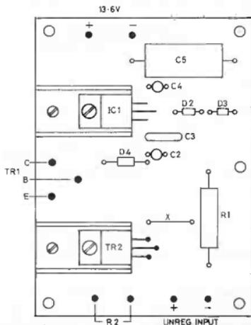
Fig. 6 PCB LOCATION OF COMPONENTS (Full size)
