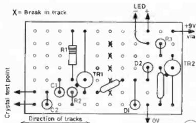
Fig 2 CRYSTAL CHECKER VEROBORD LAYOUT
