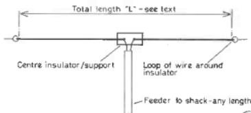
Fig. 4 PRACTICAL HALF WAVE DIPOLE CONSTRUCTION
