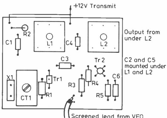
Fig. 4 TRANSMIT MIXER LAYOUT (actual size)
