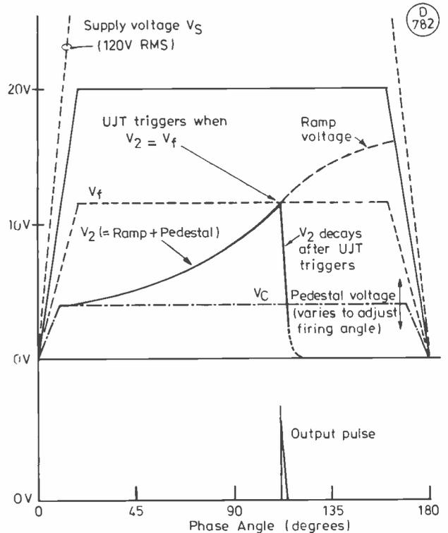
A4 SINGLE (HALF) CYCLE WAVEFORMS FOR Fig. 2
