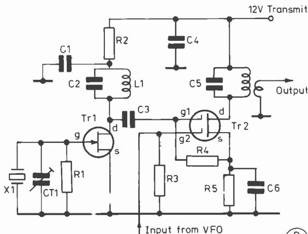
Fig.1 TRANSMIT MIXER CIRCUIT
