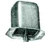
**HORIZONTAL BLOCKING-OSCILLATOR TRANSFORMER**
