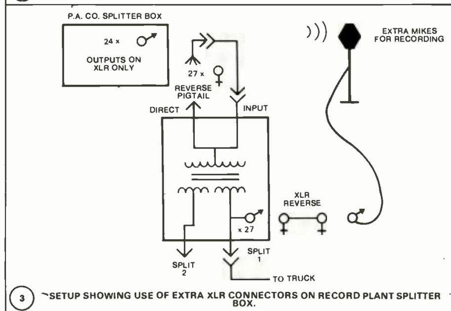
3 SETUP SHOWING USE OF EXTRA XLR CONNECTORS ON RECORD PLANT SPLITTER BOX.
