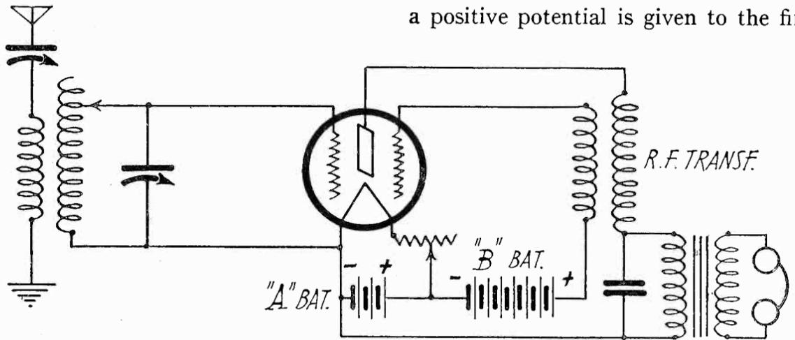
Fig. 3. Rectification Circuit.
