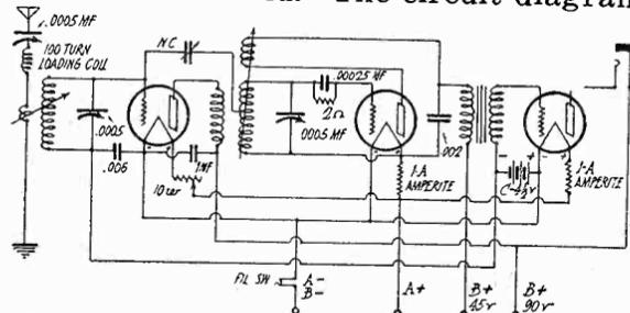
Fig. 2. 600 Meter Browning-Drake Circuit
