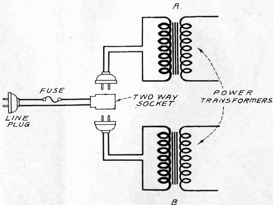
**WHEN A RADIO RECEIVER IS WHOLLY OR PARTIALLY OPERATED FROM SOCKET POWER A ONE AMPERE FUSE SHOULD BE PUT IN THE SUPPLY LINE TO PROTECT THE INSTALLATION AGAINST SHORTS AND OVERLOADS**
