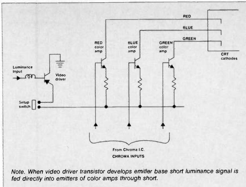
Fig. 3. Zenith 9-89 video output module
