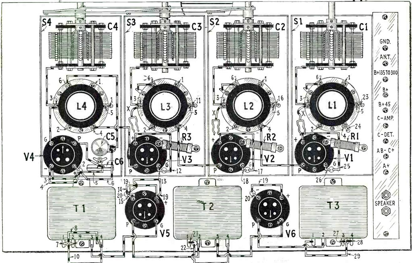
WIRES MARKED X CLIP TO TERMINAL ON TOP OF SHIELDED-GRID TUBES
