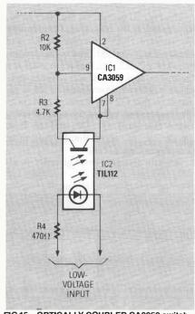
FIG 15—OPTICALLY COUPLED CA3059 switch.
