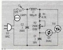
FIG 23-SIMPLE LAMP DIMMER.
