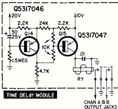
Fig. 4—The time-delay module.
