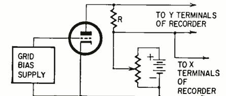
R IS LOW-VALUE RESISTOR JUST LARGE ENOUGH TO BUILD UP THE Y VOLTAGE OF THE RECORDER
