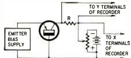
R IS LOW-VALUE RESISTOR JUST LARGE ENOUGH TO BUILD UP THE Y VOLTAGE FOR THE RECORDER
