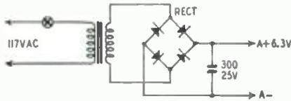
Fig. 11—Dry-rectifier d.c. filament supply.
