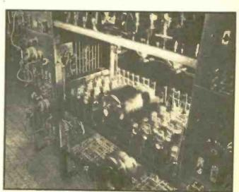
VIBRATION TEST FOR TUBES
